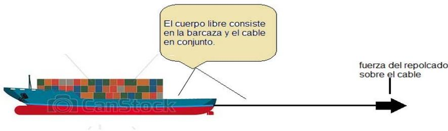
Figura 2. Diagrama de cuerpo libre para la barcaza y el cable.
